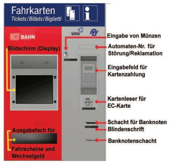
Die Automaten werden durch Berühren des Bildschirmes bedient. Das gewünschte Ticket wird durch Berühren der Flächen ausgewält. Nach der Bezahlung wird das Ticket gedruckt und mit dem Wechselgeld ausgeworfen.
